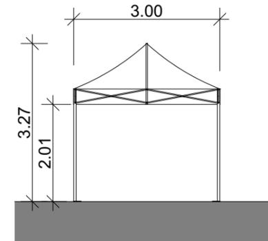
QUERSCHNITT FALTZELT 3X6 METER
